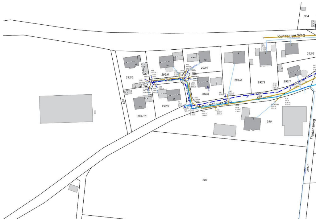
Systemplan Entwässerungsanlage unmaßstäblich
